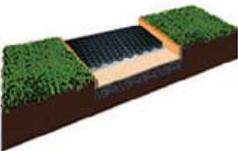
Nachdem der Untergrund verdichtet ist, muss eine Trägerschicht aus Sand aufgetragen werden. Verdichten Sie die Oberfläche und ziehen sie diese entsprechend dem Geländeverlauf glatt.
