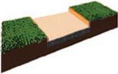
Für die gesamte zu bearbeitende Fläche ist eine Randbefestigung notwendig. Sie schützt den Rand der Kiesmatte vor mechanischer Beschädigung. Randbefestigungen können aus unterschiedlichen Materialien bestehen. Wir empfehlen Edelstahl-, Zinkstahl-, Kunststoff bzw. Holz-Befestigungen. Erfahrungsgemäß sollte die Randbefestigung, je nach Nutzung, eine Höhe von 5 – 15 cm aufweisen. Für die Ausrichtung an der Umgebung empfiehlt sich ein Laserhöhenmesser.
