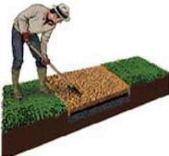
Befüllen Sie nun die Matten mit Kies/Splitt der Korngröße 4 - 16 mm und verteilen ihn mit geeigneten Werkzeugen. Decken Sie die Matten mit einer 2 cm starken Kiesschicht über Wabenhöhe ab. Im Laufe der Zeit wird sich diese noch auf eine Höhe von 1,5 - 1 cm komprimieren.
